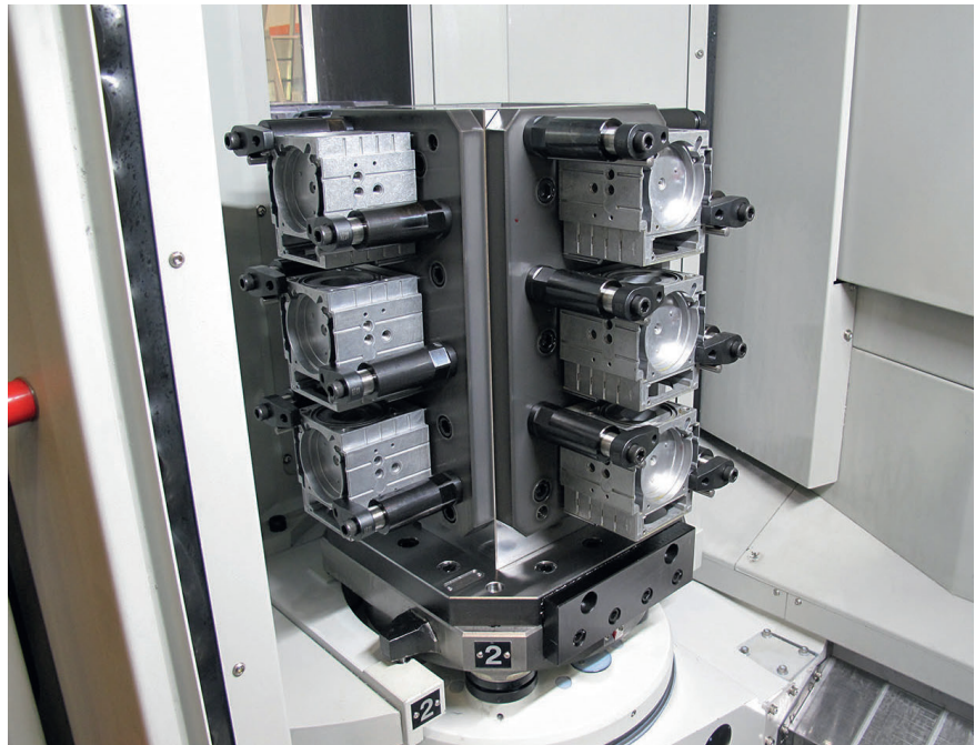
2 Flexibel automatisierbar: Ein Palettenwechsler zum hauptzeitparallelen Spannen mehrerer Bauteile bietet die Möglichkeit, unproduktive Nebenzeiten zu reduzieren; Hommel bietet weitere Automationslösungen an, beispielsweise via Roboter © Hommel
